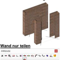
Mit diesem Befehl wird eine Wand in zwei Teile geteilt. Die Trennkante ist hierbei nicht sichtbar.
