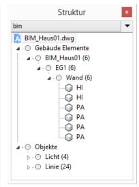
Innerhalb der Baumstruktur können einzelne Objekte oder, durch Auswahl eines Baum-Verzeichnisses, die beinhalteten Objekte dieses Baum-Knotens ausgewählt werden. Wählt man z. B. den Knoten "Wand(6)", werden sämtliche Wände der BauCaD-Geschoss-Ebene "EG1" im Gebäude "BIM Haus01" in der Zeichnung markiert. Umgekehrt werden in der Zeichnung gewählte Objekte Strukturdialogfenster hervorgehoben.
