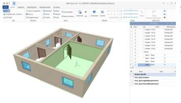
BIM-Zum Betrachten des Volumenmodells können BIM-Viewer kostenfreie geladen werden. Zusätzlich zur gerenderten Darstellung, wird die IFC-Struktur der einzelnen Volumenkörper in einer Tabelle angezeigt. Einzelne BIM-Objekte können wechselseitig in der grafischen Darstellung oder in der Tabelle markiert werden.
