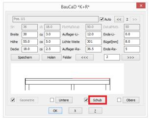
Über Unterzug-Maske die die für Erstellung von ein- und mehrfeldrigen Unterzügen in der Ansicht und im Schnitt können nun auch für die Schubbewehrung Bügel mit einer Schenkelverlängerung in die Decke verwendet werden.
