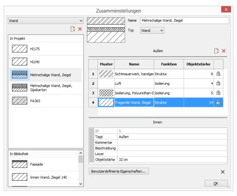
Wänden kann ein mehrschaliger Schichtaufbau als einzelne Zusammenstellung zugewiesen werden.
