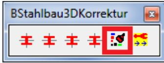
Mit diesem Befehl kann ein beliebiger Volumenkörper, also auch über den Holzbau erzeugte Volumen, in 3D-Stahlträger umgewandelt werden.
