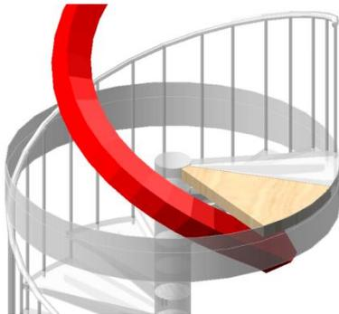
Die Kopfhöhe, als lichte Durchgangshöhe, wird spiralförmig nach dem Einbau dargestellt. Sie dient als optisches Hilfsmittel für den Austritt (Siehe Kapitel 1.3).
