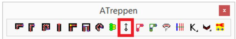
Mit diesem Befehl wird eine Treppenlauflinie in 2D erzeugt.
