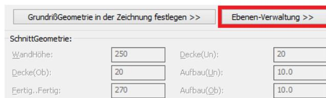
Die geschossabhängigen Höhen werden standardmäßig über die Ebenen verwaltet. "Wandhöhe", "Decke oben" und "Aufbau unten", werden aus der aktuellen Ebene übernommen. "Aufbau oben" aus der darüber liegenden Ebene und "Decke unten" aus der darunter liegenden. Dadurch werden Höhen-Änderungen in der Ebenenverwaltung direkt auf die betreffenden Geschosstreppen übertragen und diese automatisch geändert.
