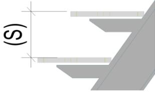
Geben Sie die Anzahl der Steigungen ein. Die Steigung **(S)** wird über die Treppenformel ermittelt und wird durch Änderung der Anzahl neu berechnet.
