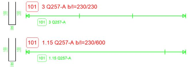
Mit diesem Befehl werden Biegematten verlegt.
